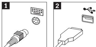
3. O cabo do rato poderá estar equipado com um conector de rato padrão **1** ou um conector USB **2**. Ligue o cabo de rato ao conector de rato apropriado.
