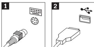
3. Kabel miške ima lahko standardni spojnik **1** ali spojnik USB **2**. Povežite kabel miške z ustreznim spojnikom miške.
