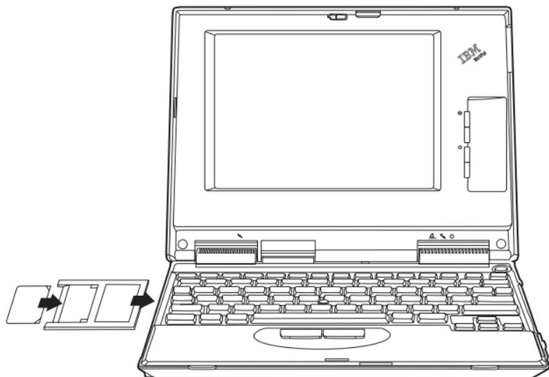
3. マイクロドライブを PC カード・アダプターに慎重に、しっかりと挿入する。
