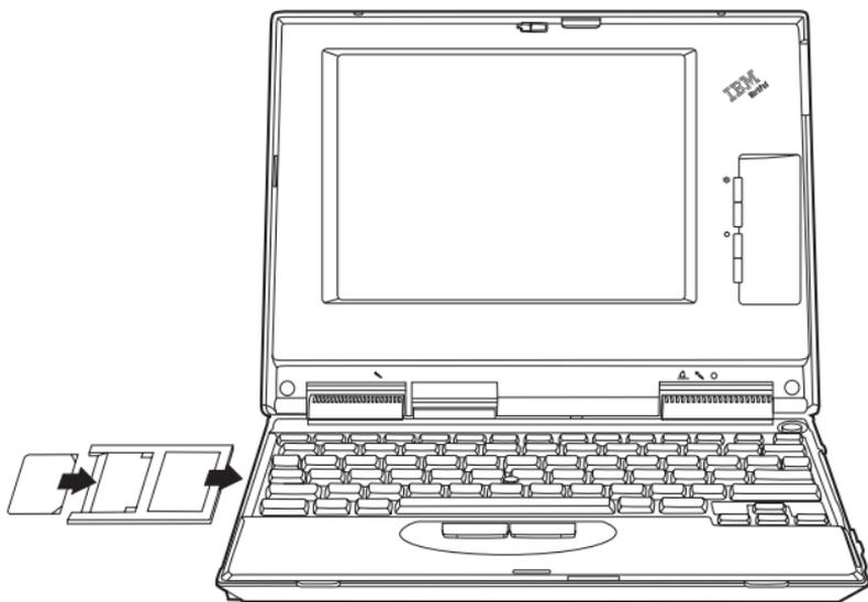
3. Con cuidado, inserte bien la unidad Microdrive en el adaptador de tarjeta PC.
