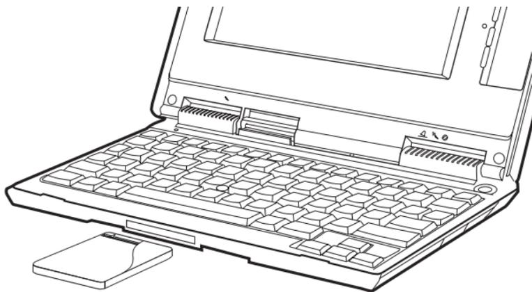
Windows CE は、自動的にマイクロドライブを構成します。マイクロドライブは、スクリーンに表示される「ストレージ カード」というタイトルのフォルダーによって表されます。
