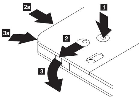
Utilizando a ponta de uma caneta esferográfica, empurre e force a presilha do pino da trava **1**. Para remover o disco, utilize uma caneta esferográfica para empurrar a trava da tampa do cartucho **2** e puxe a tampa do cartucho para fora **3**. Quando a tampa estiver aberta, o disco poderá ser removido.
