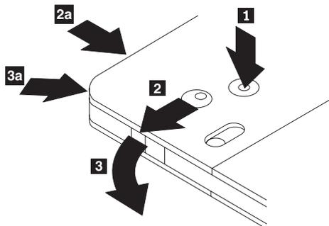
Verwenden Sie die Spitze eines Kugelschreibers, um die Lasche des Verschluss-Stifts **1** herunterzudrücken und abzubrechen. Um den Datenträger zu entnehmen, verwenden Sie einen Kugelschreiber, um den Verschluss des Kassettendeckels **2** herunterzudrücken und den Kassettendeckel **3** herauszuziehen. Ist der Kassettendeckel geöffnet, kann der Datenträger entnommen werden.
