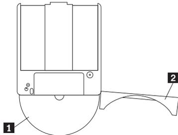
Um den Datenträger wieder in die Kassette einzulegen, richten Sie die beschriftete Seite des Datenträgers **1** an der beschrifteten Seite der DVD-RAM-Kassette aus. Legen Sie den Datenträger ein, und schließen Sie den Verschluss der Kassette **2**. Der Verschluss der Kassette rastet beim Schließen hörbar ein.
