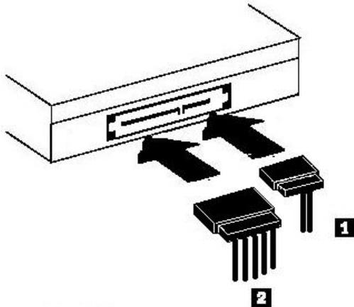
1. Schließen Sie den Anschluss eines SATA-Kabels mit 7 Kontaktstiften **1** an den seriellen Anschluss am Laufwerk an.
