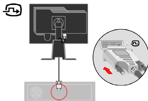
将模拟信号线接入显示器的D-SUB连接器，另一端则接在电脑后面。
