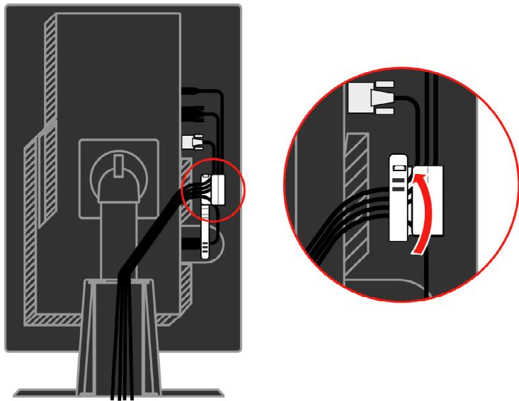
将螺旋包线缠绕在缆线上。
