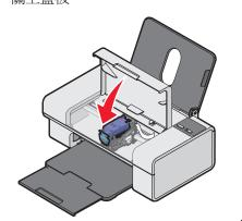
載入紙張。 1 压住进纸导轨并滑动到最左边。 Squeeze and slide the paper guide to the left. 捏住紙張導引夾然後滑向左邊
