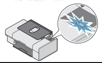
3 打开纸张支架。 Raise the paper support. 掀開紙張托架
