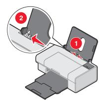
2 装入纸张,然后调节进纸 导轨到适当的位置。 Load paper, and adjust
