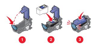
关闭顶盖。 Close the access cover. 關上蓋板。
