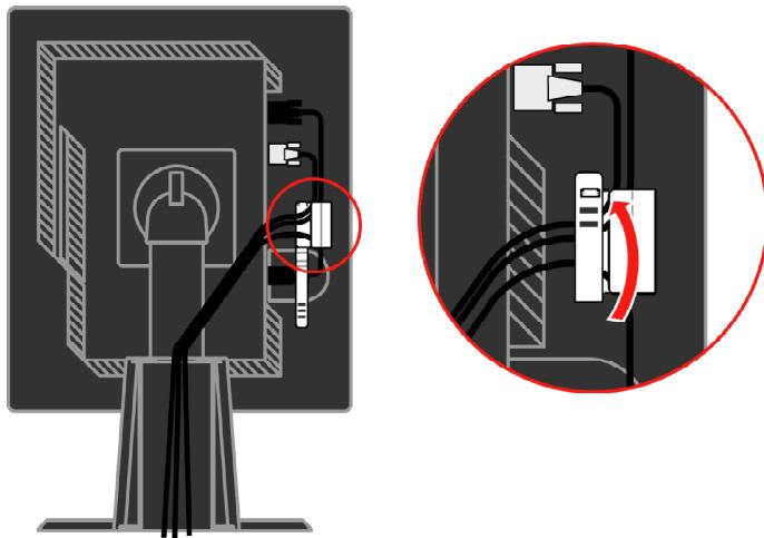
将螺旋包线缠绕在缆线上。
