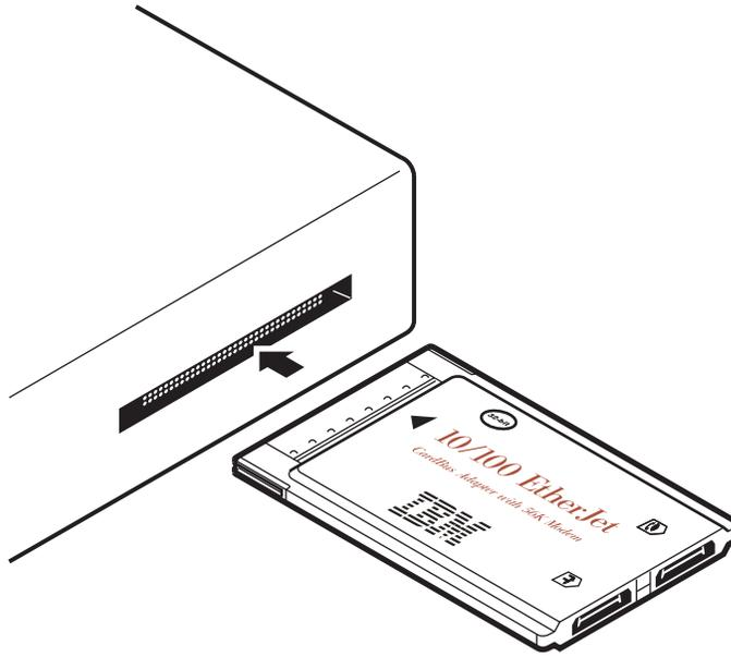
Figura 1. Inserción del adaptador CardBus en el sistema.
