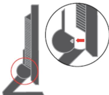
To će omogućiti pristup do vijaka koji učvršćuju postolje za monitor.
