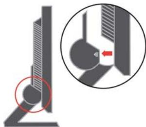
To vám umožní přístup ke šroubům, které spojují podstavec s monitorem.
