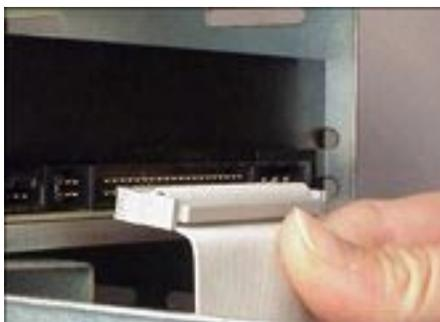
Figura 78. Interfaces de disco rígido SCSI e IDE
