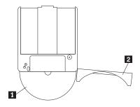
ディスクをカートリッジに戻すには、ディスク 1 のラベル・サイドを DVD-RAM カートリッジのラベ ル・サイドと合わせます。ディスクを挿入し、カートリッジのふた 2 を閉じます。カチッと音がする と、ふたのドアが確実に閉じています。
