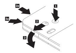
ボールペンの先端を使用して、ロック・ピン・タブ 1 を押して、外します。ディスクを取り出すには、 ボールペンを使用して、カートリッジのふたのロック 2 を押し下げ、カートリッジのふた 3 を引き出 します。カートリッジのふたを開けると、ディスクを取り外せます。
