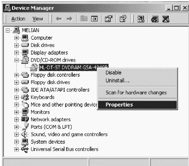
4. 「プロパティ」タブを選択し、下の図に示されているように、「ディジタル・オーディオを使用可能にする (Enable Digital Audio)」チェック・ボックスにチェックマークを付けます。
