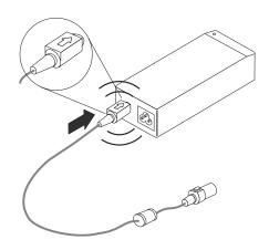
注:機内電源コネクターをアダプターから取り外すには、コネクターのスリーブ をつかんで後方にスライドさせ、コネクターをアンロックします。コネクターが 取り外されるまで、コネクター・スリーブを引き続けます。損傷を避けるため、 コネクターを取り外す際にコードを引っ張らないでください。
