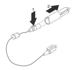
2. そのコネクターに DC 電源コードの小さい方の端を差し込みます (以下の図を参 照)。カチッと音がするまで、DC電源コードを完全に差し込んでください。
