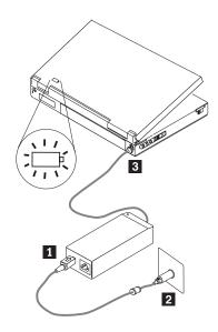
注: アダプターは、24 ボルトの電気系統の自動車での使用はサポートしていませ ん。
