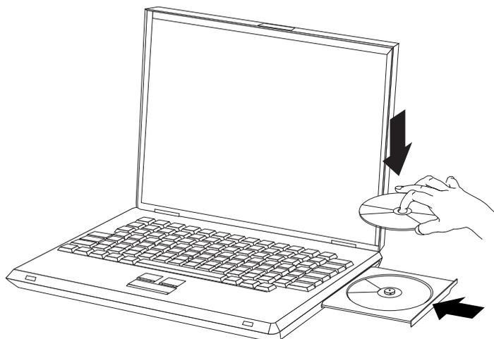
1. Pulse el botón de expulsión. La bandeja se desliza afuera de la unidad.
