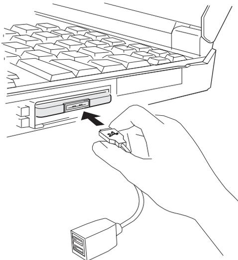
**Atenção:** O cabo da placa tem pinos para alinhamento adequado no conector da Placa ThinkPad USB 2.0 CardBus e deve ser encaixado cuidadosamente no local. Não force a conexão. Isso poderá causar danos à placa ou à extremidade do cabo.
