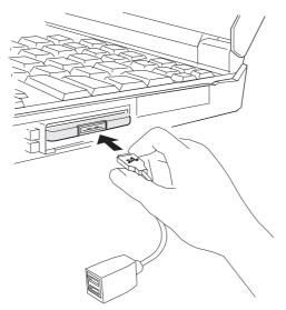
**Avvertenza:** Il cavo della scheda presenta dei piedini per consentire l'allineamento appropriato nel connettore della scheda CardBus di ThinkPad USB 2.0 e viene inserito con un leggero scatto. Non forzare la connessione. Un'eventuale forzatura potrebbe danneggiare la scheda o l'estremità del cavo.
