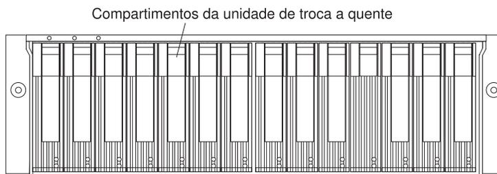
Figura 1. Compartimentos da Unidade de Troca a Quente FAStT EXP700
