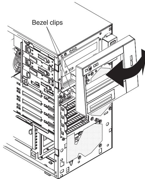
*Figure 3. Removing the upper bezel*
