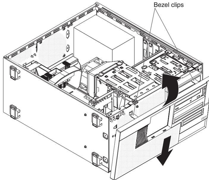
Figure 12. Installing the new bezel
