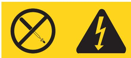
Existen niveles perjudiciales de energía, corriente y voltaje en los componentes que tienen adherida esta etiqueta. Dentro de estos componentes no existe ninguna pieza que requiera mantenimiento. Si sospecha que alguna de estas piezas tiene un problema, póngase en contacto con un técnico de servicio.
