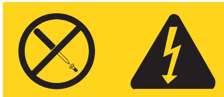
Des tensions et des courants dangereux sont présents à l'intérieur de tout composant sur lequel est apposée cette étiquette. Ces éléments ne peuvent pas être réparés. Si vous pensez qu'ils peuvent être à l'origine d'un incident, prenez contact avec un technicien de maintenance.
