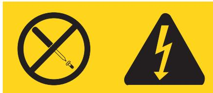
In Komponenten, die so gekennzeichnet sind, können gefährliche Spannungen anliegen. In diesen Komponenten sind keine Teile vorhanden, die vom Benutzer gewartet werden müssen. Besteht der Verdacht, dass an einem dieser Teile ein Fehler aufgetreten ist, ist ein IBM Kundendiensttechniker zu verständigen.
