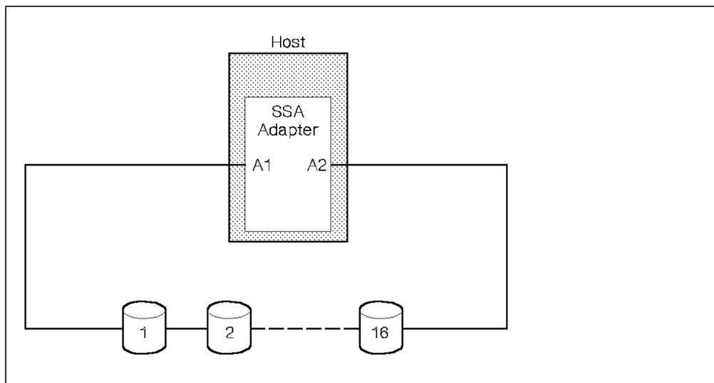
Figure 17. A Simple SSA Disk Subsystem
