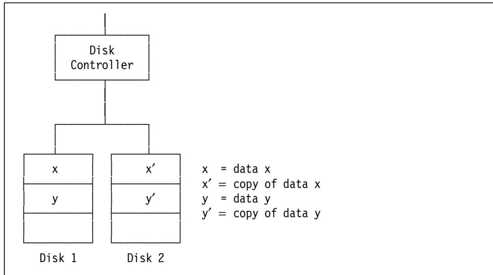
Figure 23. RAID-1 (Disk Mirroring)
