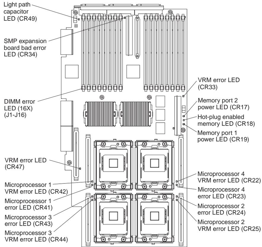
Figure 5. SMP Module LEDs
