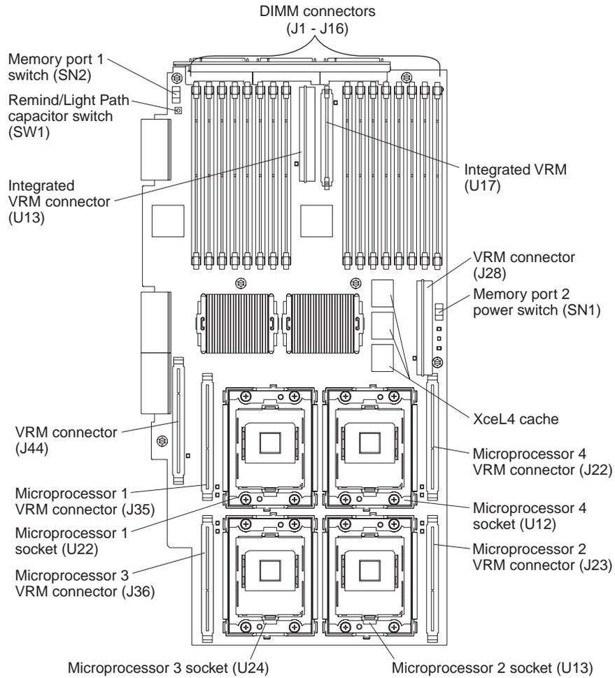
Figure 4. SMP Module connectors
