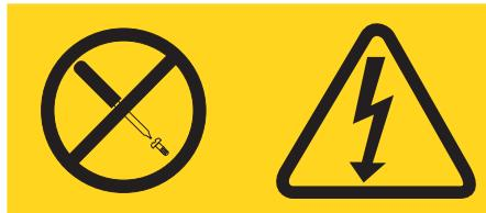
任何贴有该标签的组件内部都存在危险的电压、电流和能级。这些组件内部没有可维修的部件。如怀疑该类部件中的某一个有问题, 请联系服务技术人员。
