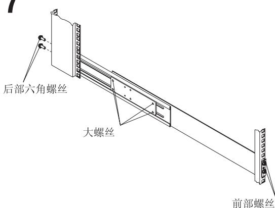
将导轨拉到后部机架安装凸缘外部；然后安装并拧紧两个后部 M6 六角螺丝。
