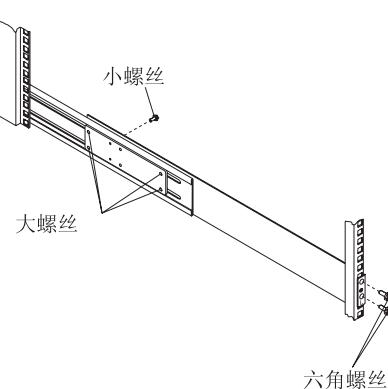
在标有 **L** 的导轨上，卸下并保存好小螺丝；然后松开四个大螺丝。将导轨抵住左侧机架安装凸缘外侧并插入前部 M6 六角螺丝（此时尚未拧紧）。
