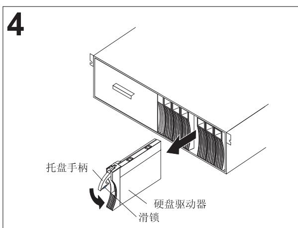
要卸下硬盘驱动器，请按下滑锁并将手柄向上拉；然后，将驱动器小心地从存储子系统拉出。
