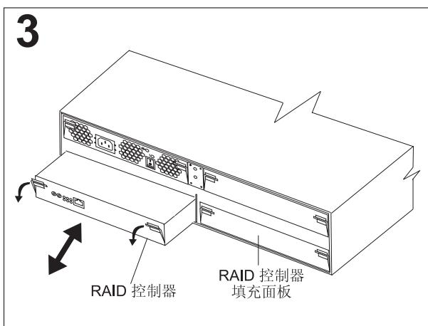
要卸下后部的组件（RAID 控制器、带风扇电源部件或填充面板）：
