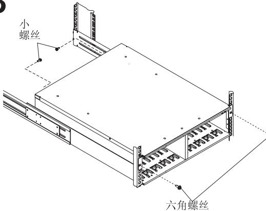
将存储子系统完全滑入机架；然后，用两个 M6 六角螺丝固定存储子系统的前部。
