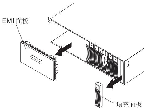
从剩余的硬盘驱动器托架中卸下填充面板。如果有一个空白面板覆盖了存储子系统一侧的所有七个硬盘驱动器托架，则要抓住手柄向外拉，以卸下该面板。
