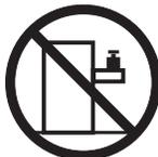
Não coloque nenhum objeto com peso superior a 82 kg (180 lbs.) sobre dispositivos montados em rack.
