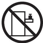
Non poggiare oggetti che pesano più di 82 kg sulla parte superiore delle unità montate in rack.
