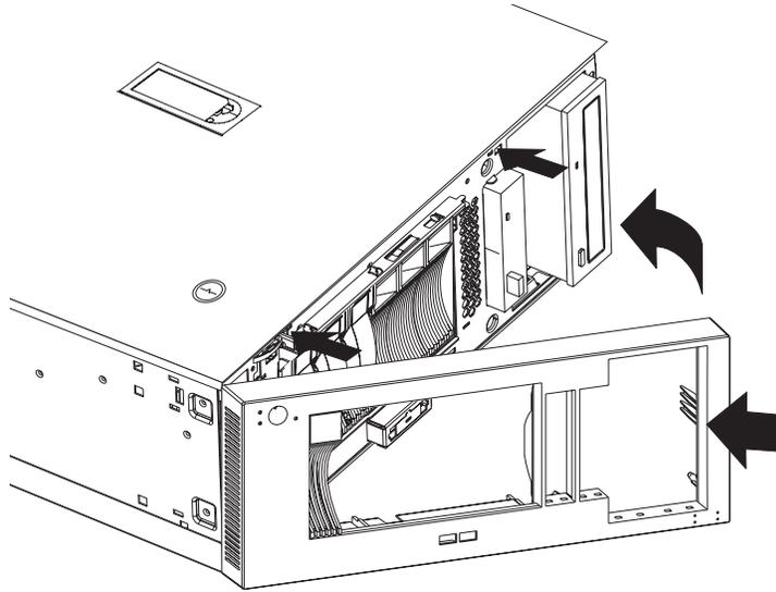
*Figure 14. Installing the new system bezel*
