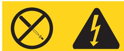
In Komponenten, die so gekennzeichnet sind, können gefährliche Spannungen anliegen. In diesen Komponenten sind keine Teile vorhanden, die vom Benutzer gewartet werden müssen. Besteht der Verdacht, dass an einem dieser Teile ein Fehler aufgetreten ist, ist ein IBM Kundendiensttechniker zu verständigen.
