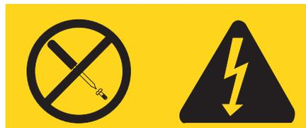
Tensioni pericolose, corrente e livelli di energia sono presenti all'interno del componente su cui è posta questa etichetta. All'interno di questi componenti non vi sono parti su cui effettuare l'assistenza tecnica. Se si sospetta un problema in una di queste parti, rivolgersi ad un tecnico di manutenzione.
