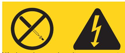
Níveis perigosos de voltagem, corrente e energia estão presentes em qualquer componente que tenha esta etiqueta afixada. Nenhuma peça localizada no interior desses componentes pode ser consertada. Se você suspeitar de algum problema em alguma dessas peças, entre em contato com um técnico IBM.
