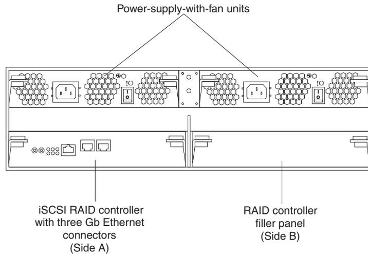
Figure 3. DS300 (1701-1RS) storage subsystem rear view
