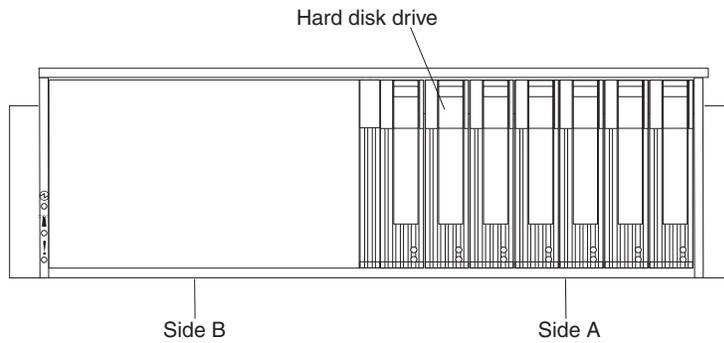
Figure 2. DS300 (1701-1RL) storage subsystem front components
