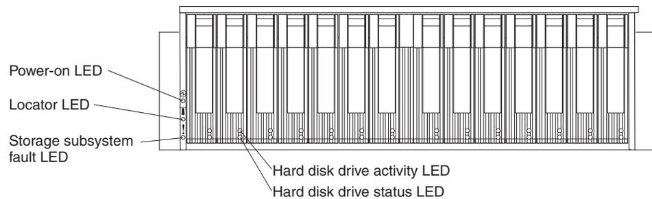
Figure 26. DS300 and DS400 storage subsystem front LEDs
