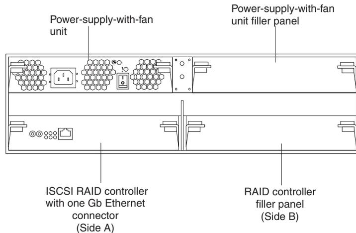
Figure 4. DS300 (1701-1RL) storage subsystem rear view
