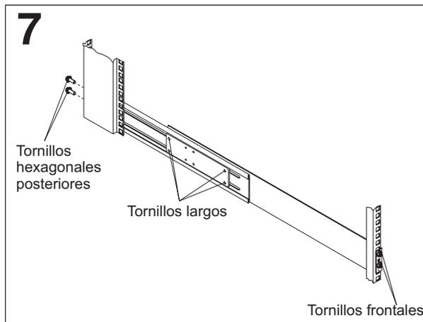
Extienda el riel fuera de la brida posterior de montaje en bastidor; a continuación, coloque y apriete los dos tornillos hexagonales M6 de la parte posterior.
