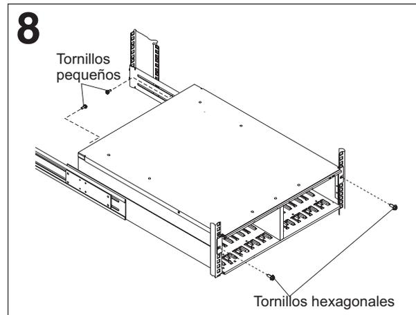
Deslice el subsistema de almacenamiento en el bastidor hasta que quede colocado en su posición; a continuación, fije la parte frontal del subsistema de almacenamiento con dos tornillos hexagonales M6.
