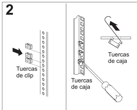
Coloque las tuercas de caja o de clip según sea necesario para el bastidor. Utilice un destornillador de punta plana para colocar las tuercas de caja.
