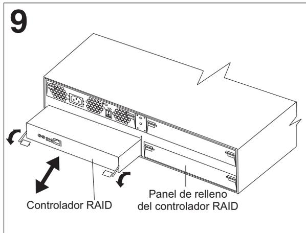
Para instalar un componente en la parte posterior (controlador RAID, fuente de alimentación con ventilador o panel de relleno):
