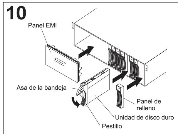
Coloque las unidades de disco duro y los paneles de relleno extraídos en los pasos 4 y 5.
