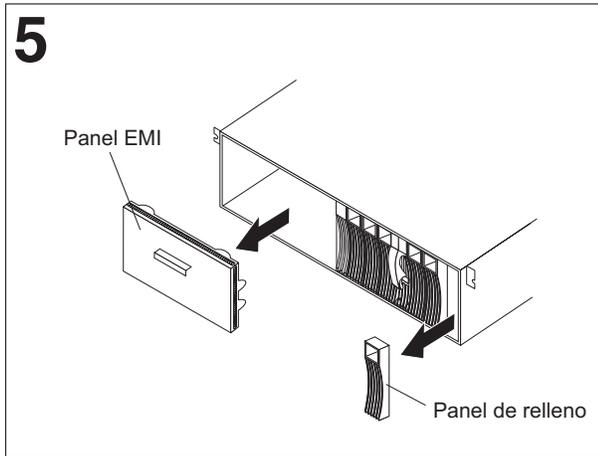
Extraiga los paneles de relleno de las demás bahías de unidad de disco duro. Si un panel de espacio vacío cubre las siete bahías de las unidades de disco duro en uno de los lados del subsistema de almacenamiento, agarre el asa y estire de ella para extraer el panel.
