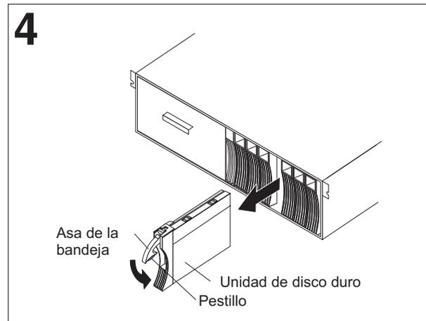
Para extraer una unidad de disco duro, presione el pestillo y tire del asa hacia arriba; a continuación, extraiga con cuidado la unidad de disco duro del subsistema de almacenamiento.
