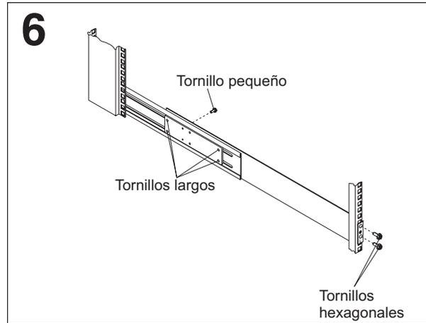
En el riel marcado con una L, extraiga el tornillo pequeño y guárdelo; a continuación, afloje los cuatro tornillos largos. Sujete el riel sobre la parte externa de la brida izquierda de montaje en bastidor y coloque los tornillos hexagonales M6 frontales sin apretarlos demasiado.
