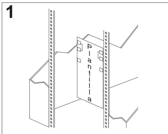
Utilice la plantilla adjunta de montaje en bastidor para localizar los orificios de las bridas frontales y posteriores de montaje en bastidor. Pase por alto el término "marco biselado" de la plantilla.
