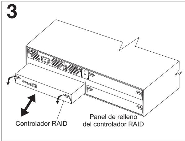
Para extraer un componente de la parte posterior (controlador RAID, fuente de alimentación con ventilador o panel de relleno):
