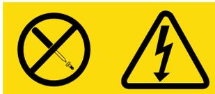
Questa etichetta indica la presenza di livelli di tensione e di energia pericolosi all'interno del componente. La manutenzione dei componenti interni non è effettuabile da parte dell'utente. Se si ritiene che uno di questi componenti sia guasto, contattare un tecnico esperto.
