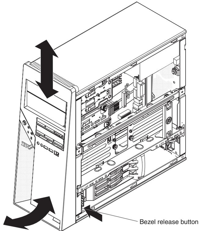
Figure 12. Installing the bezel
