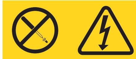
Los componentes con este tipo de etiquetas tienen en el interior un nivel de voltaje, de corriente y de energía peligrosos. Dentro de estos componentes no existe ninguna pieza que requiera mantenimiento. Si sospecha de la existencia de algún problema en una de estas piezas, póngase en contacto con el servicio técnico.
