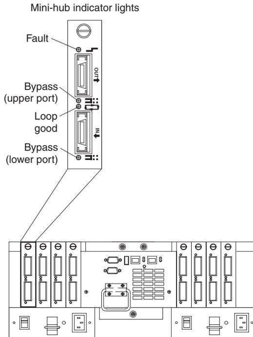
Figure 160. FAST500 RAID controller mini hub indicator lights
