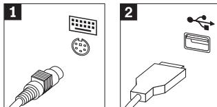
3. Το καλώδιο του ποντικιού μπορεί να έχει είτε ένα κανονικό βύσμα ποντικιού (σχήμα 1) είτε βύσμα USB (σχήμα 2). Συνδέστε το καλώδιο του ποντικιού
