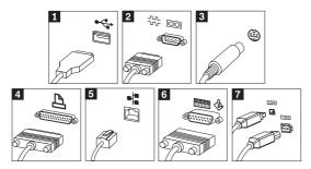
USB Utilice estos conectores para conectar un dispositivo que precise conexión USB (Bus serie universal), como un ratón, escáner, una
