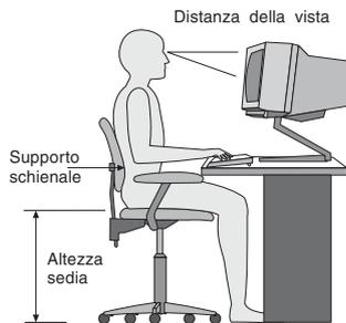
Regolare il video in modo che la parte superiore dello schermo si trovi al livello degli occhi o leggermente al di sotto. Posizionare il video ad una distanza tale da non causare problemi alla vista, generalmente a 51-61 cm e posizionarlo in modo da poter vedere senza dover assumere posizioni
