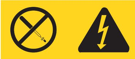
Quaisquer componentes que tenham esta etiqueta anexada, possuem interiormente voltagem perigosa, corrente e níveis de energia. Nenhuma peça no interior desses componentes pode ser consertada. Se você suspeitar de um problema com uma dessas peças, entre em contato com um técnico de serviço.
