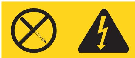
Внутри данного устройства присутствует опасное напряжение, течёт сильный ток и выделяется значительная энергия. Внутри этих узлов нет деталей, подлежащих обслуживанию. Если вы полагаете, что с какой-то из этих деталей возникла проблема, обратитесь к специалисту.
