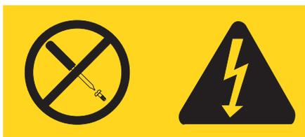
Esta etiqueta indica um dispositivo com tensão, corrente eléctrica ou níveis de energia perigosa. Nenhum componente existente no interior do dispositivo requer qualquer ajuste ou manutenção por parte do utilizador. Contacte um técnico de assistência se suspeitar de algum problema num dos componentes.
