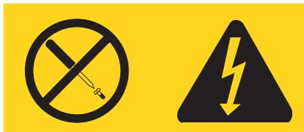
위와 같은 라벨이 부착되어 있는 모든 부품에는 인체에 위험을 주는 전압이나 전하량 및 에너지 수준이 존재합니다. 이러한 부품의 내부에는 수리할 수 있는 부분이 없습니다. 위와 같은 라벨이 부착된 부품의 고장이 의심스러운 경우, LG IBM 서비스 센터에 연락을 취하십시오.
