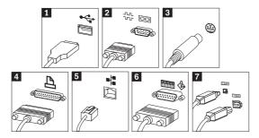
USB Permet de relier un périphérique nécessitant une connexion USB (scanner, souris, imprimante ou assistant électronique).
