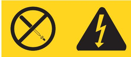
I livelli di tensione, corrente pericolosi sono presenti all'interno dei componenti dotati di questa etichetta. All'interno dell'unità non vi sono parti su cui effettuare l'assistenza tecnica. Se si sospetta di un problema con uno di questi componenti, contattare un responsabile tecnico.
