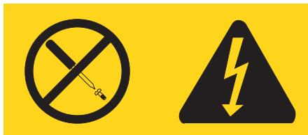
Binnen componenten waarop dit label is bevestigd, bevinden zich gevaarlijke spannings-, stroom- of energieniveaus. Deze componenten bevatten geen onderdelen die kunnen worden vervangen of onderhouden. Als u een probleem met een van deze onderdelen vermoedt, waarschuw dan een onderhoudstechnicus.
