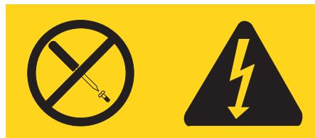
Unutar svake komponente na kojoj se nalazi ovakva naljepnica su prisutne rizične razine napona, električnog toka i energije. Unutar tih komponenti nema dijelova koji se mogu servisirati. Ako sumnjate da postoji problem s nekim od tih dijelova, обратите се техничару у сервису.
