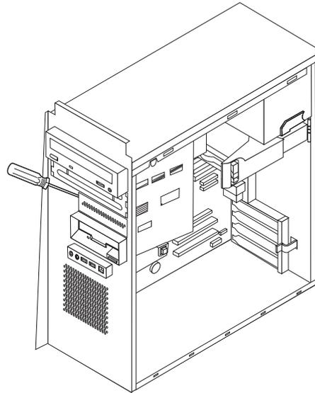
4. Los puentes de las unidades PATA deben colocarse como dispositivo maestro o esclavo. Las unidades de disco duro SATA no necesitan puentes de dispositivo maestro ni esclavo. Si está instalado una unidad de disco duro SATA, siga con el paso 6.
