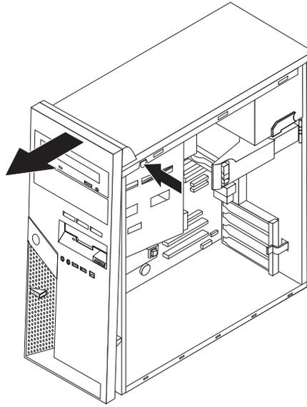
3. Retire el protector de metal de la bahía de la unidad 3 con un destornillador de punta plana haciendo palanca suavemente hasta que se suelte.
