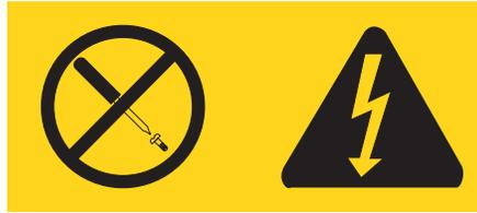
En el interior de los componentes que tienen pegada esta etiqueta existen niveles de voltaje, corriente y energía que son peligrosos. Dentro de estos componentes no existe ninguna pieza que requiera mantenimiento. Si sospecha que puede haber un problema en una de estas piezas, póngase en contacto con un técnico de servicio.
