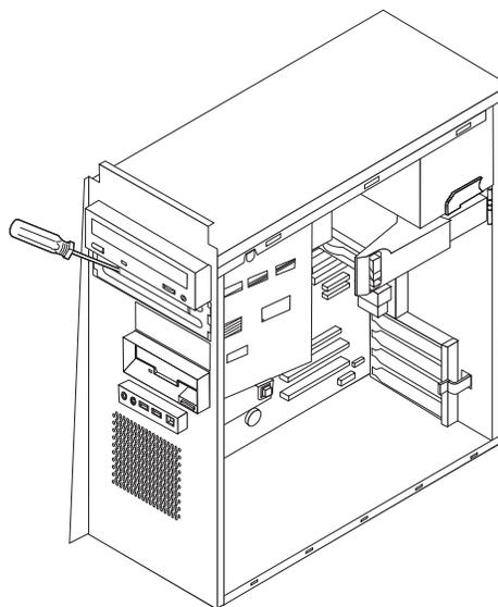
4. Si va a instalar una unidad con soporte accesible, como una unidad óptica, retire el panel de plástico del marco biselado apretando las pestañas de plástico que fijan el panel en el interior del marco biselado.
