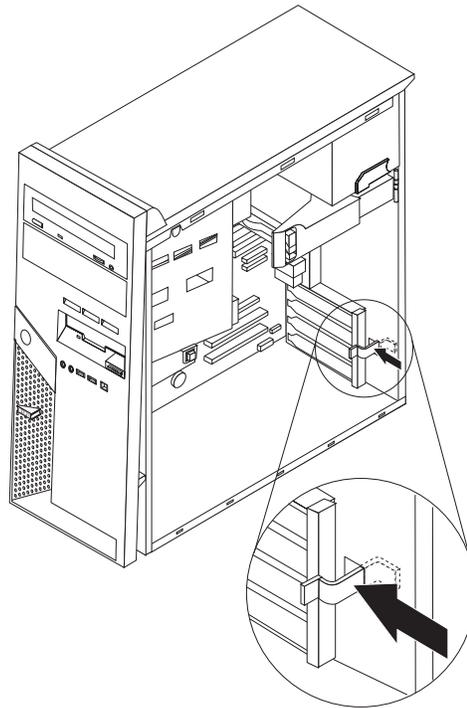
3. Extraiga la cubierta del conector de expansión adecuado.
