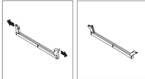
4. Sitúe el módulo de memoria sobre el conector de memoria. Asegúrese de que la muesca **1** del módulo de memoria esté alineada correctamente con la ranura **2** del conector de la placa del sistema. Presione el módulo de memoria hacia abajo y recto dentro del conector de memoria hasta que se cierren los clips de sujeción.
