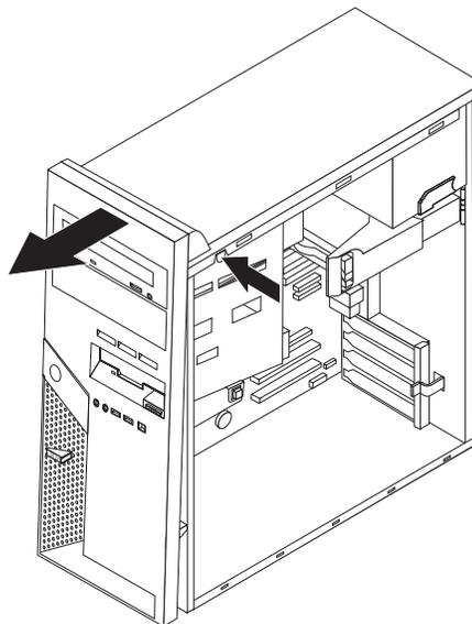
3. Retire el protector de metal de la bahía de la unidad con un destornillador de punta plana haciendo palanca suavemente hasta que se suelte.
