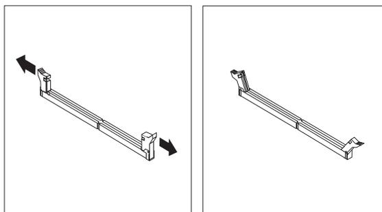
6. Assurez-vous que l'encoche **1** du module de mémoire s'aligne correctement sur la clé du connecteur **2** de la carte mère. Enfoncez le module de mémoire dans le connecteur jusqu'à ce que les crochets de retenue se referment.
