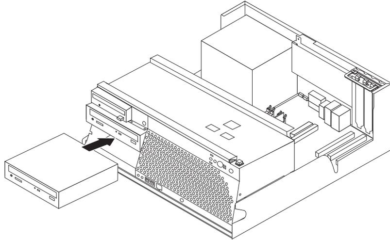
9. Une unité de disque dur requiert deux câbles ; un cordon d'alimentation qui se connecte au bloc d'alimentation et un câble d'interface qui se connecte à la carte mère.
