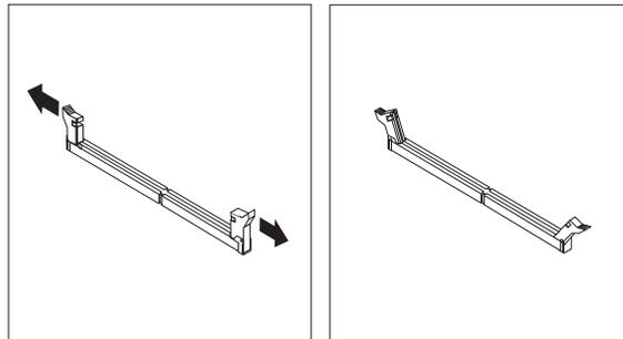
6. Asegúrese de que la muesca **1** del módulo de memoria esté alineada correctamente con la ranura **2** del conector de la placa del sistema. Presione el módulo de memoria hacia abajo y recto dentro del conector hasta que se cierren los clips de sujeción.
