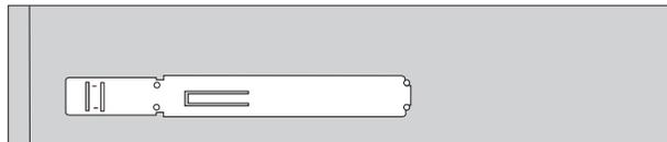
7. En el caso de una unidad de 3,5 pulgadas, instale la unidad en la pieza de sujeción adaptadora universal de 5,25 a 3,5 pulgadas.
