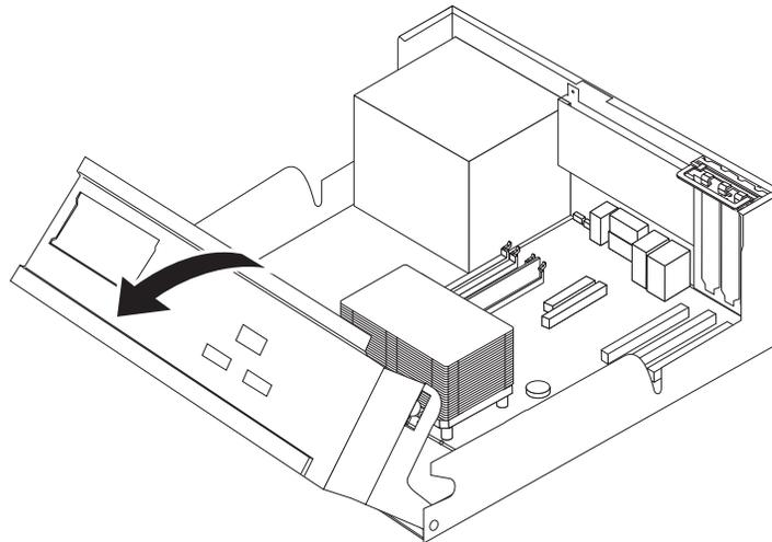
3. Abra el pestillo de la cubierta de la ranura y quite la cubierta del conector de expansión adecuado.
