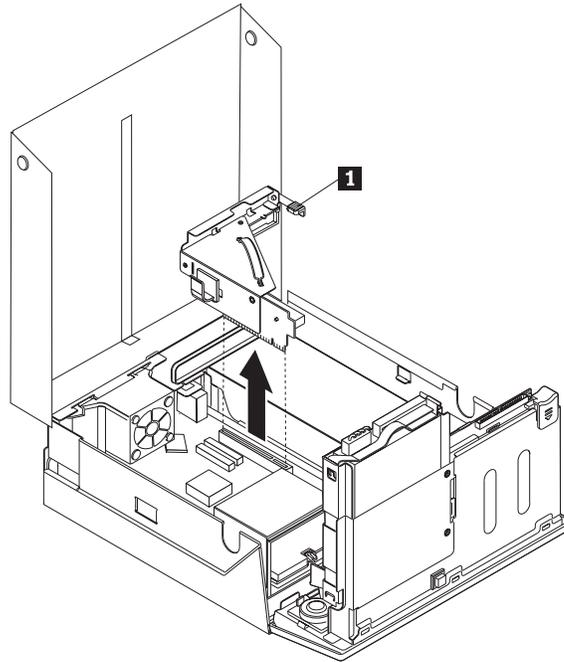
6. Gire hacia arriba el pestillo del adaptador **1** y después extraiga la cubierta de la ranura para el conector de expansión.
