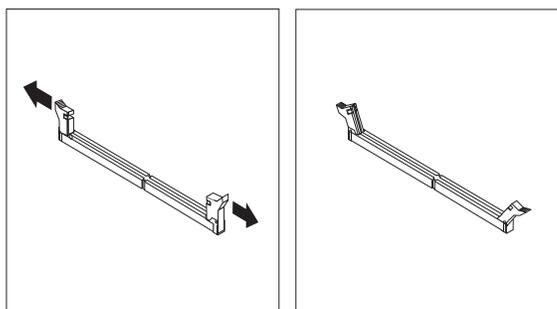
5. Asegúrese de que las muescas **1** del módulo de memoria queden alineadas correctamente con las ranuras del conector **2** en la placa del sistema. Presione hacia abajo y recto el módulo de memoria dentro del conector hasta que se cierren los clips de sujeción.
