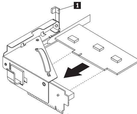
9. Gire hacia abajo el pestillo del adaptador **1** para sujetar el adaptador.
