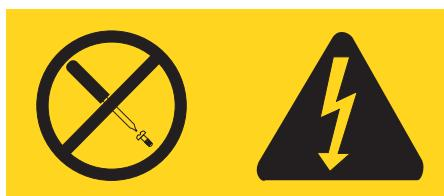
위와 같은 라벨이 부착되어 있는 모든 부품에는 인체에 위험을 주는 전압이나 전하량 및 에너지 수준이 존재합니다. 이러한 부품의 내부에는 수리할 수 있는 부분이 없습니다. 위와 같은 라벨이 부착된 부품의 고장이 의심스러운 경우, 서비스 센터에 연락하십시오.
